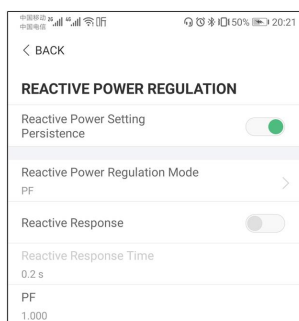
Afbeelding 7-17 Regeling van reactief vermogen
